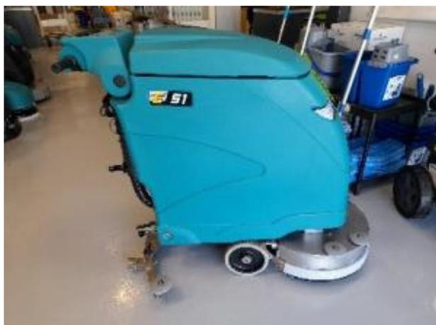
Largeur de travail: 53cm, cuve 40L, largeur suceur 83cm, traction par la brosse, dimensions: 1317x555x1110 (h) Rendement théorique 2120m<sup>2</sup>, autonomie 2h30 à 3h00...
