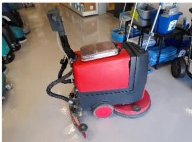
Autolaveuse CLEANFIX RA501B à batteries. Largeur de travail 50 cm, réservoir eau propre 32 litres, largeur d'aspiration: 80cm, autonomie 2h30, Poids avec batteries: 119 kg, pression sol 44kg, dimensions 114 x 56 x 82 (h), équipée d'une brosse PPL, rendement théorique: 2000m<sup>2</sup>/h. Cuve en PEHD antichoc, batteries 76Ah sans entretien.
